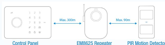
**HU** A jelerősítőt a megfelelő helyre kell helyezni. A repeater és a kontroll panel távolsága maximálisan 300 méter legyen (nyílt terpen). A repeater és a tartozékok távolsága maximum 90 méter legyen (nyílt terpen). Az alábbi képen látható, a megfelelő hely. A mozgásérzékelőt, mint egy mintatartozék használjuk.
